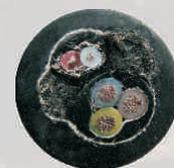
Гибкий гибридный кабель является комбинацией кабеля DMX и электропитающего кабеля. Конструкция объединяет два независимых кабеля: электропитания и управления сценическим оборудованием. Двойное экранирование кабеля DMX и экран силового кабеля
