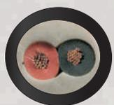
Огнестойкий акустический кабель E90 (90 минут целостности конструкции кабеля и непрерывной работы сети в условиях пожара). Во время пожарных испытаний кабели подвержены воздействию огня температурой 830°C-870°C и механическим нагрузкам.
