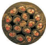
Профессиональный кабель мультипар для передачи аналоговых сигналов. Каждая пара индивидуально экранирована лентой из алюминиевого полиэстера с защитной медной жилой. Высокие параметры передачи данных, а также механические характеристики позволяют использовать данный кабель как в студийном, так и в сценическом оборудовании.
