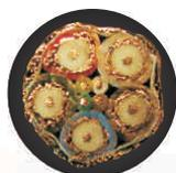
Гибридная конструкция этого кабеля позволяет передавать видеосигнал по 5 коаксиальным проводникам, а сигналы управления по 4 дополнительным жилам сечением 0,12 мм<sup>2</sup>. Кабель подходит для применения внутри помещений и не требует дополнительной защиты при его использовании вне помещений. Защитная медная жила обеспечивает защиту от электромагнитных помех и высокую гибкость. Использование гибридных кабелей облегчает монтаж, уменьшая его стоимость.
